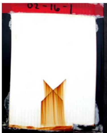
壓克力底漆/面漆+MANCHEM 441
