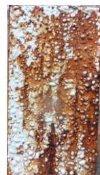
SPF799-115R-1 油性光油(直接塗佈銹蝕瓷漆) 白色塗料(SCHWEGO CORRIT)
