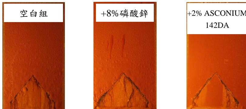
2. 油性聚酯捲鋼塗料/乾膜厚：20 $\mu$ m/SST(ASTM B117) $\times$ 1500 小時
