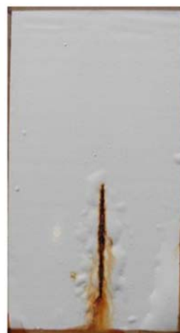
直接塗在銹蝕上的 油性光油
