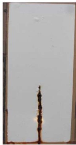
直接塗在銹蝕上的 油性光油
