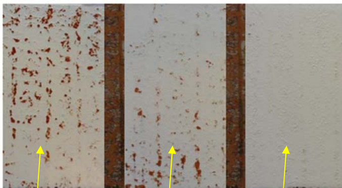
左：未使用 ASCOTRUST 中：添加 5% 抗閃銹劑 右：使用 ASCOTRUST®
