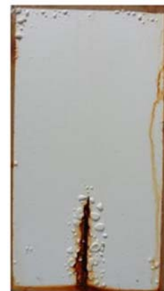
水性金屬塗料系統直接 應用在已除銹鋼板
